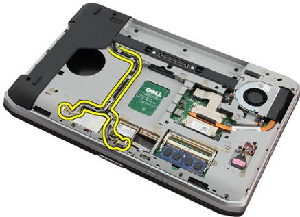
12. Trennen Sie das LVDS-Kabel (Low Voltage Differential Signaling)
