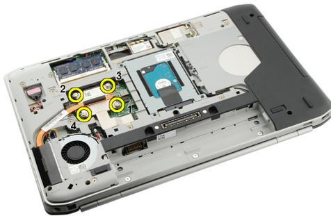
6. Heben Sie den Kühlkörper an und entfernen Sie ihn aus dem Computer.
