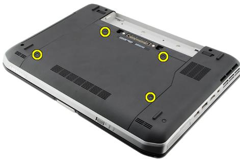
4. Schieben Sie die Rückseite in Richtung der Gehäusevorderseite und entfernen Sie sie.
