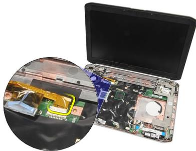
**14.** Ziehen Sie die Antennenkabel durch die Öffnung an der Oberseite des Computers.
