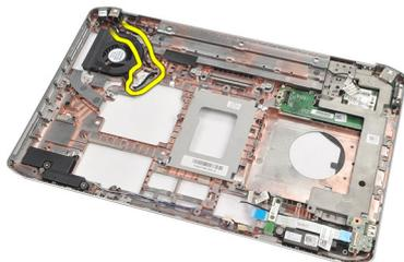
25. Entfernen Sie den Stromversorgungsanschluss.
