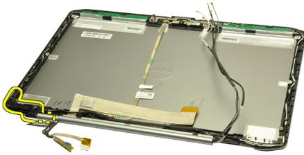
19. Lösen und entfernen Sie den linken Scharnierschacht von den Kabeln.
