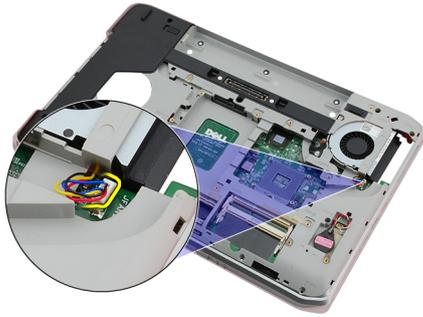
25. Entfernen Sie das DC-In-Kabel.
