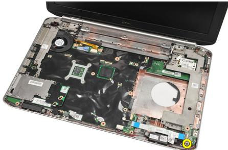
12. Entfernen Sie die Audioplatine.
