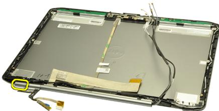
18. Entfernen Sie die linke Bildschirmscharnierkappenschacht.
