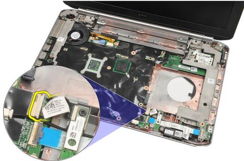
10. Entfernen Sie die Schraube zur Befestigung der Bluetooth-Karte.
