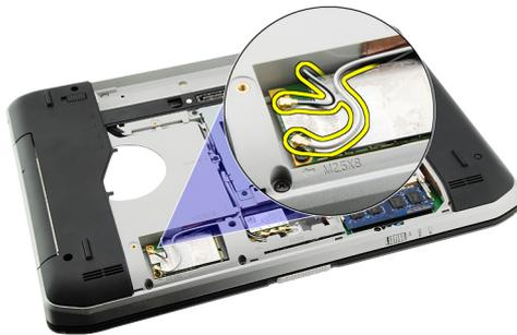
5. Entfernen Sie die Schraube, mit der die WWAN-Karte an der Systemplatine befestigt ist.
