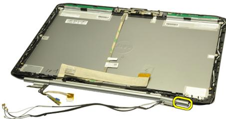
14. Drehen Sie den rechten Bildschirmscharnierschacht in eine vertikale Position.
