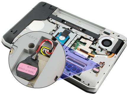
6. Hebeln Sie die Knopfzellenbatterie heraus und lösen Sie sie vom Kleber.
