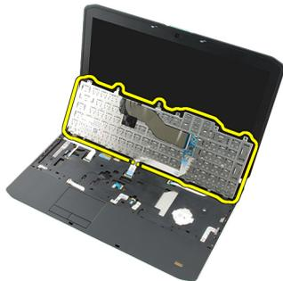
10. Lösen Sie das Tastaturdatenkabel und nehmen Sie sie aus dem Computer.
