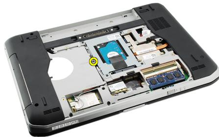
5. Drücken Sie die Schraubklammer vom Computer weg, um das optische Laufwerk aus dem Laufwerkschacht zu lösen.
