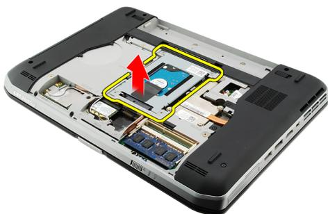
6. Entfernen Sie die die Schrauben der Festplattenlaufwerkhalterung.
