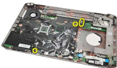
28. Heben Sie die rechte Seite der Systemplatine an, um sie von den Port-Anschlüssen zu lösen und entfernen Sie die Systemplatine.
