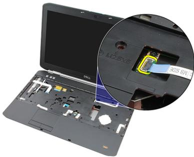
14. Trennen Sie das Fingerprint-Kabel.
