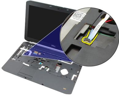
11. Trennen Sie das LED-Stromversorgungskabels.
