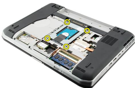
5. Verwenden Sie die Klammer, um die Festplattenlaufwerkhalterung nach oben zu ziehen und entfernen Sie sie aus dem Computer.
