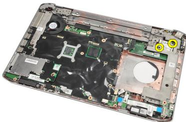
13. Heben Sie die Modemkarte an, um den Anschluss an der Rückseite der Karte zu lösen und entfernen Sie sie vom Computer.
